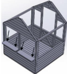
**8.** Colocar el contador lateral y atornillar en los agujeros preestablecidos para tal efecto con los tornillos de 40 mm como se muestra en la imagen.
