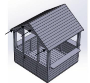
**14.** Colocar la cubierta de la cresta del techo y atornillar en los agujeros preestablecidos para tal efecto con los tornillos de 25 mm como se muestra en la imagen.
