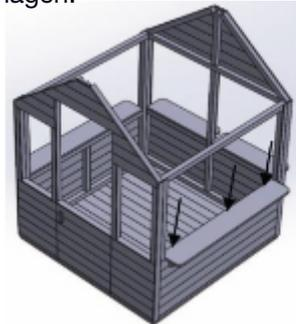
**10.** Colocar un panel superior. Atornillar en los agujeros preestablecidos para tal efecto con los tornillos de 70 mm como se muestra en la imagen.
