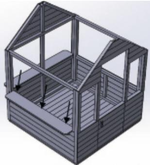
**9.** Colocar el otro contador lateral y atornillaren los agujeros preestablecidos para tal efecto con los tornillos de 40 mm como se muestra en la imagen.
