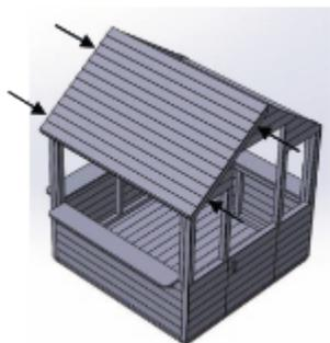
**11.** Colocar el otro panel superior. Atornillar en los agujeros preestablecidos para tal efecto con los tornillos de 70 mm como se muestra en la imagen.
