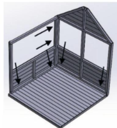
5. Colocar el otro panel lateral y atornillar en los agujeros preestablecidos para tal efecto con los tornillos de 70 mm como se muestra en la imagen.
