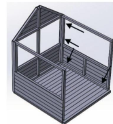
**6.** Colocar el panel frontal y atornillar en los agujeros preestablecidos para tal efecto con los tornillos de 70 mm como se muestra en la imagen.
