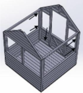
**7.** Colocar el contador trasero y atornillar en los agujeros preestablecidos para tal efecto con los tornillos de 40 mm como se muestra en la imagen.
